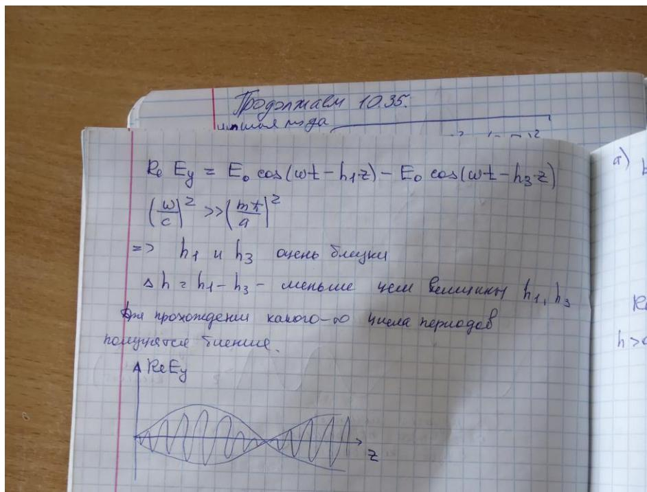
**10.4.** В прямоугольном волноводе с размерами поперечного сечения  $a$  и  $b$  на частоте  $f$  возбуждены две волны, бегущие в одном направлении. Нарисовать качественно графики зависимости электрического поля от продольной координаты  $z$  в различные моменты времени  $t$  на осевой линии волновода (пересечении диагональных плоскостей) для волн типов: а) TE10 и TE30 при  $f=1700$  б) TE10 и TE20 при  $f=1700$
