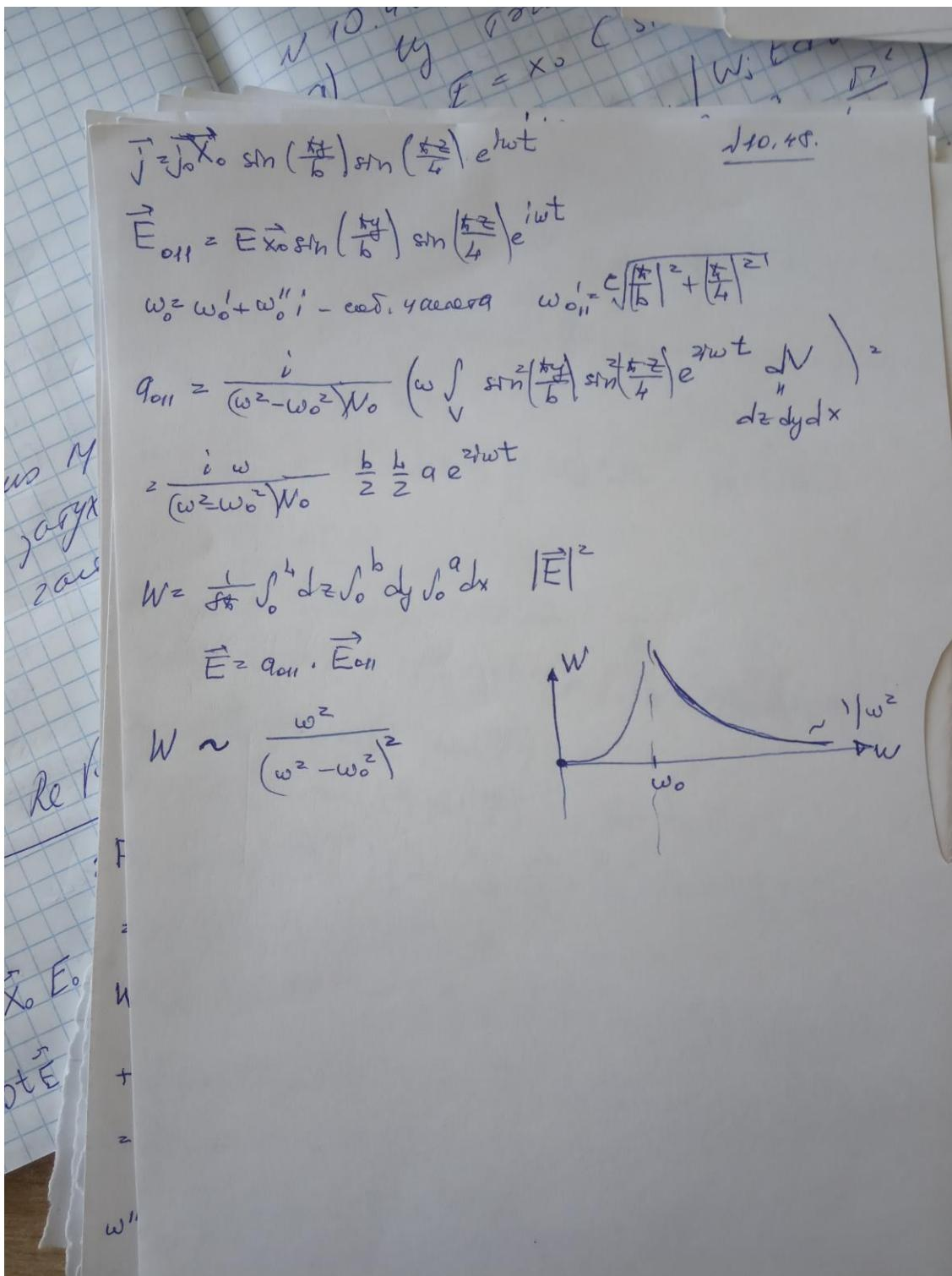
**10.48.** Полный резонатор, представляющий собой прям. параллелипипед с ребрами  $a$ ,  $b$ ,  $L$ , возбуждается изнутри заданным объемным распределением плотности переменного тока  $j = j_0 j(y, z) \exp(i\omega t)$ . Оси  $x, y, z$  направлены соответственно вдоль ребер  $a, b, L$ . Построить (кач) графики зависимости запасенной в резонаторе э/м энергии  $W$  от частоты  $\omega$  для следующих распределений тока  $j(y, z)$ :
