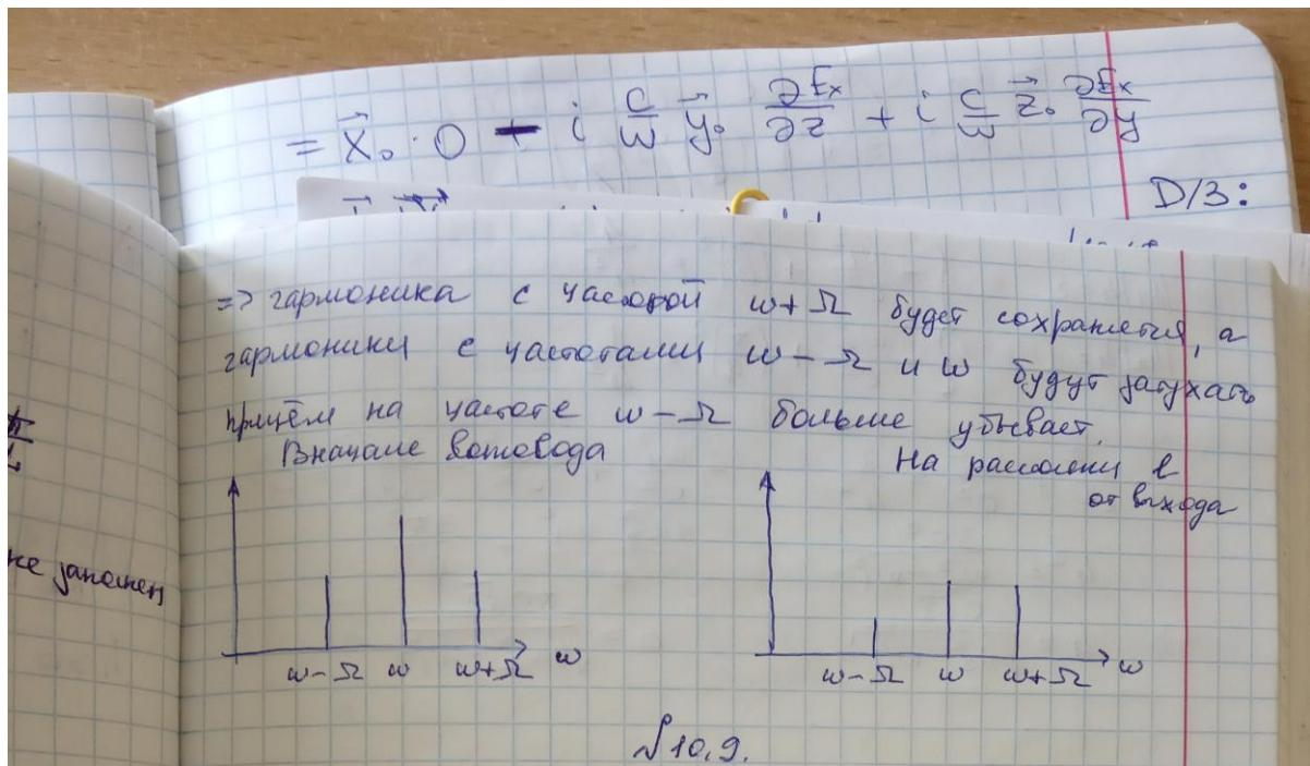
**10.8.** На входе в незаполненный прямоугольный волновод с идеально проводящими стенками волна типа  $TE_{10}$  промодулирована по амплитуде на частоте  $\Omega$ :  $E = E_0 (1 + m \cos \Omega t) \exp(iwt)$ . Ширина волновода  $a$  удовлетворяет условиям  $Pc/\omega > a > Pcs/(\omega + \Omega)$ . Как зависит частотный спектр сигнала от продольной координаты  $z$ ?
