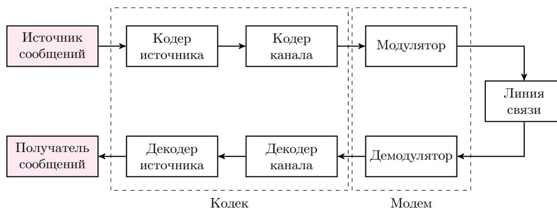
Рис. 1. Структурная схема системы передачи дискретных сообщений
