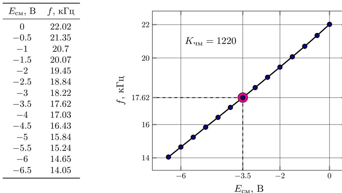
Рис. 15. Зависимость частоты от рабочей точки
