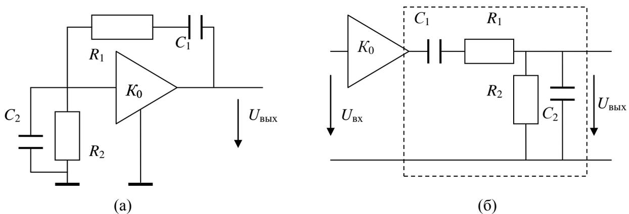
Рис. 12.  $RC$ -генератор и его эквивалентная схема
